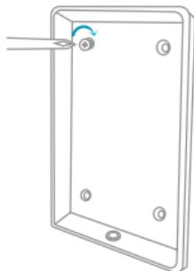
Open de behuizing van het toetsenbord, bevestig achterdeksel op de daarvoor bedoelde plek.
