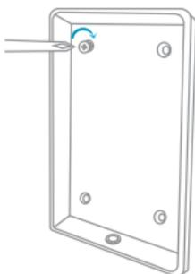
Aprire la custodia del tastierino, fissare il coperchio posteriore in una posizione di montaggio adatta.
